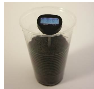
Abb. 3: Temperaturmessung im Inneren des Bechers nach Lichteinwirkung.
